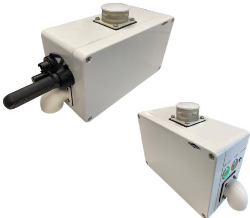
Le **LOAC** (Light Optical Aerosol Counter) est un compteur d'aérosols fournissant une concentration en particules et une nature optique moyenne d'aérosols. Cet instrument miniaturisé et polyvalent fonctionne avec une diode laser et 2 détecteurs placés respectivement à 12° et 60°, offrant ainsi un haut niveau de sensibilité.
