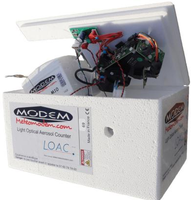
Le **LOAC** (Light Optical Aerosol Counter) est un compteur d'aérosols fournissant une concentration en particules et une nature optique moyenne d'aérosols. Cet instrument miniaturisé et polyvalent fonctionne avec une diode laser et 2 détecteurs placés respectivement à 12° et 60°, offrant ainsi un haut niveau de sensibilité.
