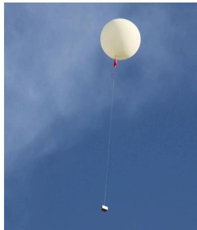
Le **LOAC Telemetry** est alimenté par 2 piles alcalines. Il peut être utilisé sous ballon captif ou ballon météorologique.
